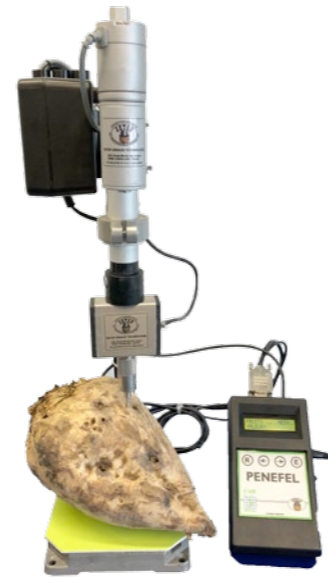
Penetrometer von SESVanderHave zur Messung der Gewebefestigkeit
