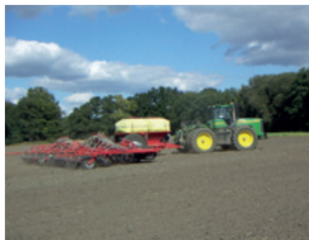
Die Aussaat der Zuckerrüben erfolgt mit einer 12 m breiten Drillmaschine von Horsch.
